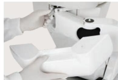
A continuación es suficiente desmontar el cárter estético para desbloquear el soporte del grupo hídrico, que pasa de un lado a otro con un simple movimiento de traslación.
