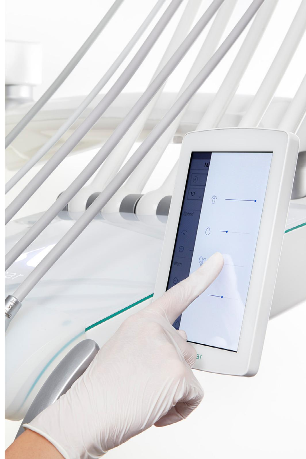
Ajuste de los parámetros de funcionamiento del micromotor (con funciones ENDO): control del par en Ncm, rotación directa o inversa, modo de riego (pulverización, control del par en Ncm, rotación directa o inversa, modo de riego (pulverización / agua / aire) , tipo de contraángulo y dos tipos de velocidades: de 200 a 40.000 rpm y de 100 a 4.000 rpm.
